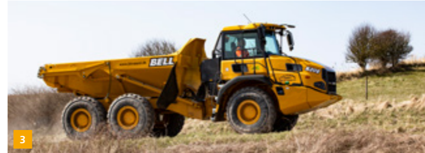
1. Sikkeret overblik med bakkamera og stor skærm. 2. Kørekømført og instrumentering i top. 3. Kassen på 11,5 m 3 har indbygget vægt.
