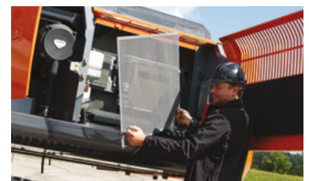
Udskiftning af brændstof-, motorolie- og luftrensingsfiltre klares fra jordniveau.
