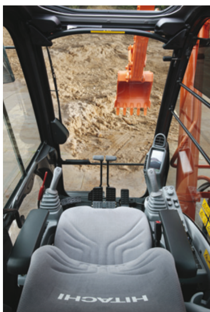
Det fuldt justerbare og opvarmede førersæde er udstyret med en ny skydemekanisme, der kan flytte sædet længere tilbage.
