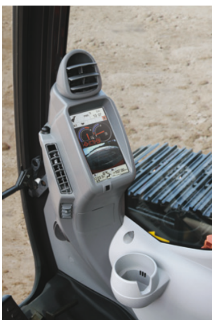
Den nye multifunktions LCD-monitor har en stor 7-tommers skærm. Skærmen og de ergonomiske udformede kontakter er grupperet indenfor højre hånds rækkevidde.
