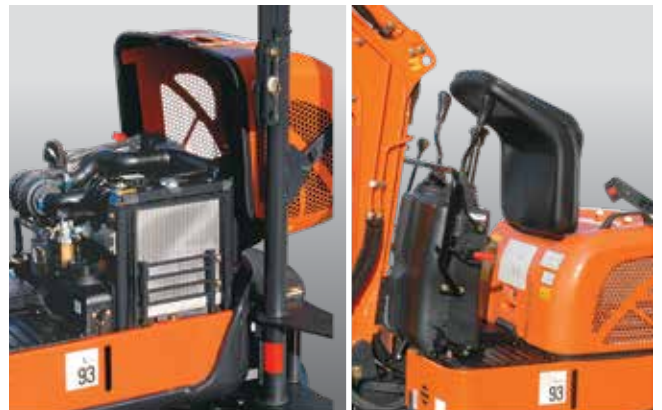
Afskærmninger med brede åbninger giver mulighed for nem vedligeholdelse.
