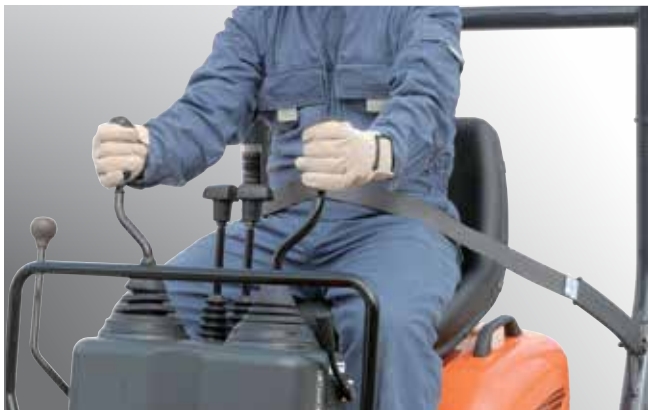
Hydrauliske pilotkontrolhåndtag sikrer problemfri betjening.
