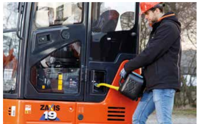
Ny placering af brændstoftankens åbning gør påfyldning nem.
