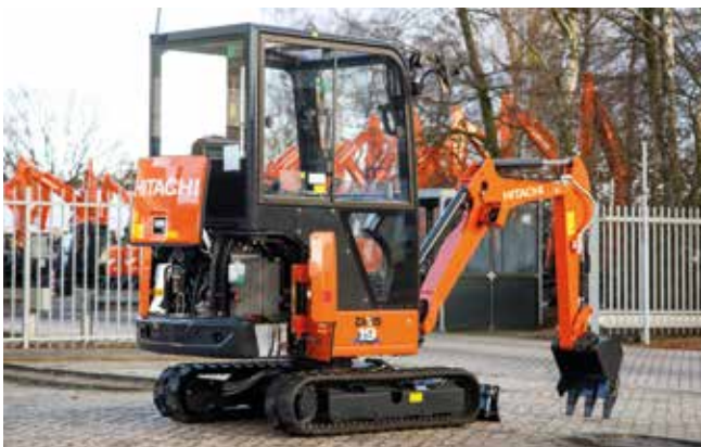
Motorafskærmningen åbnes lodret, hvilket er ideelt ved trange pladsforhold.
