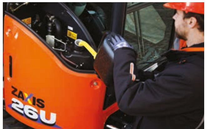
Tilstrækkelig plads omkring brændstoftankens åbning for nem påfyldning.
