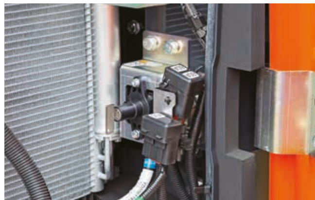
Batteri-afbryderkontakten højner sikkerheden, når der udføres vedligeholdelse.
