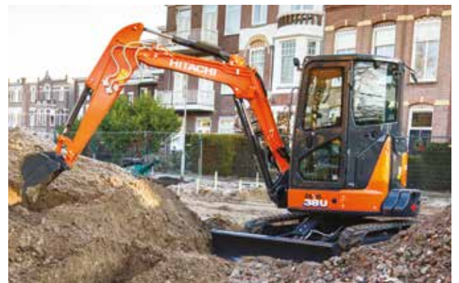
Den lille bagkrøjeradius gør ZX38U-6 særdeles velegnet til arbejde under trange pladsforhold.
