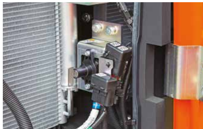
Batteri-afbryderkontakten højner sikkerheden, når der udføres vedligeholdelse.
