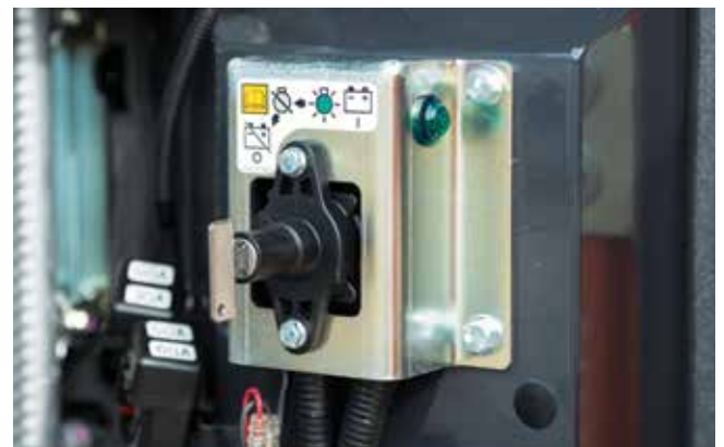
Batteri-afbryderkontakten højner sikkerheden, når der udføres vedligeholdelse.
