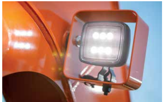
LED-lamper har længere levetid end halogen-alternativer.
