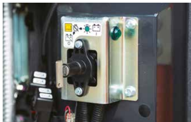
Batteri-afbryderkontakten højner sikkerheden, når der udføres vedligeholdelse.
