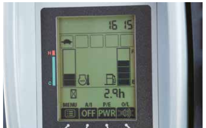
Multifunktionel LCD-skærm viser maskindata, der kan aflæses på et øjeblik.
