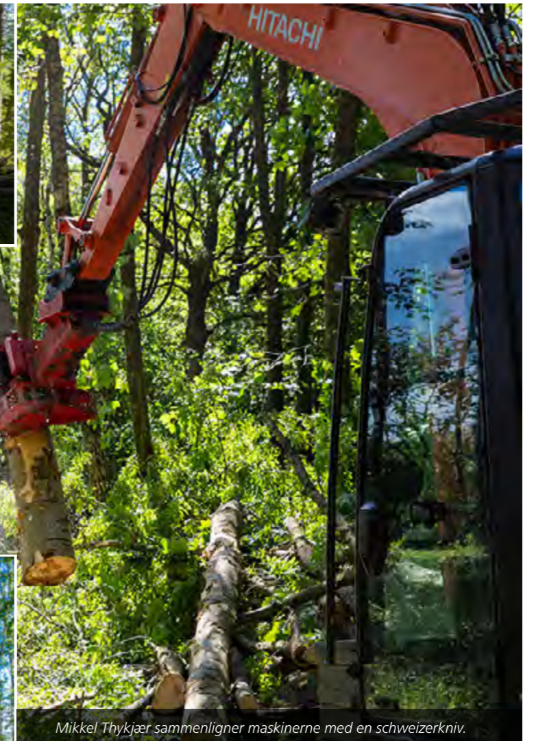
Sikkerhedsgitteret oven på kabinetaget sikrer føreren imod nedfald af grene og stammer.
