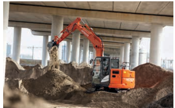
Den lille kroejradius gør ZX85USB-6 som skabt til arbejde under trange pladsforhold.
