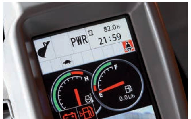
Stor multifunktionel LCD-farveskærm viser maskindata, der kan aflæses på et øjeblik.
