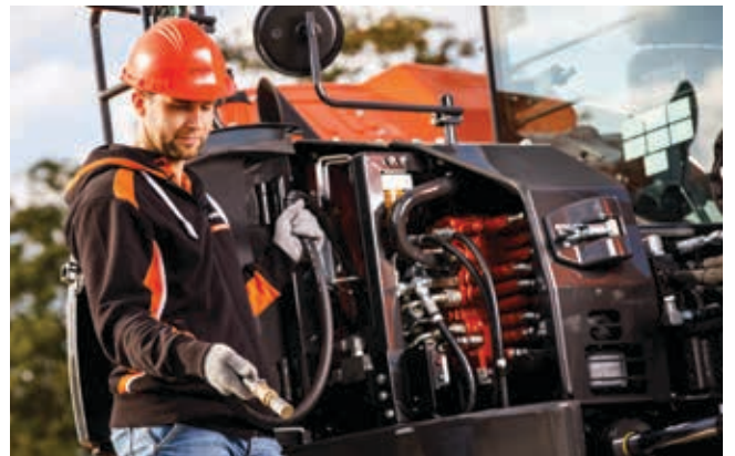
Gravemaskinen kan påfyldes med en elektrisk pumpe.
