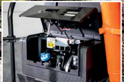
Urea (AdBlue®) indsprøjtes i udstødningssækkene til reduktion af emissioner.
