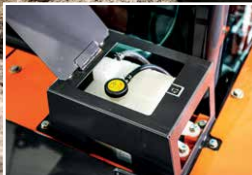
Ekspansionsbeholderen forhindrer overophedning af motordelene.
