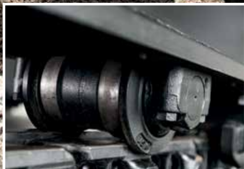
Nydesignet underrulle forhindrer jord i at trænge ind og forårsage skader.
