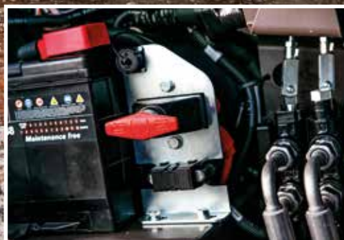
Frakoblingskontakt til batteriet for nem vedligeholdelse.
