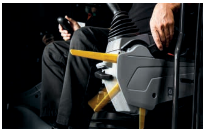
Lukkeshåndtaget til pilotkredsen øger sikkerheden i kabinen.
