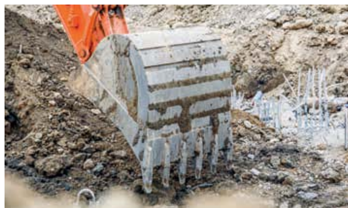
Hitachi GET omfatter selvskærpnde tænder og pålidelige adaptere for at sikre, at de passer nøjagtigt.
