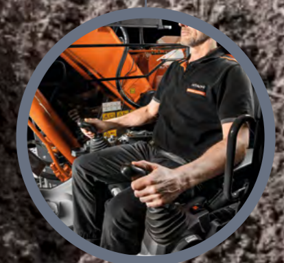
De to hydraulikhåndtag følger med, når sædet indstilles, så føreren bevarer sin arbejdsstilling.
