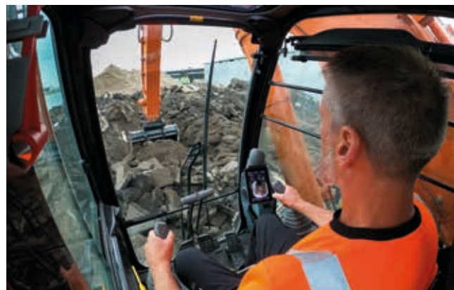
Parallelviskere giver et bedre udsyn.
