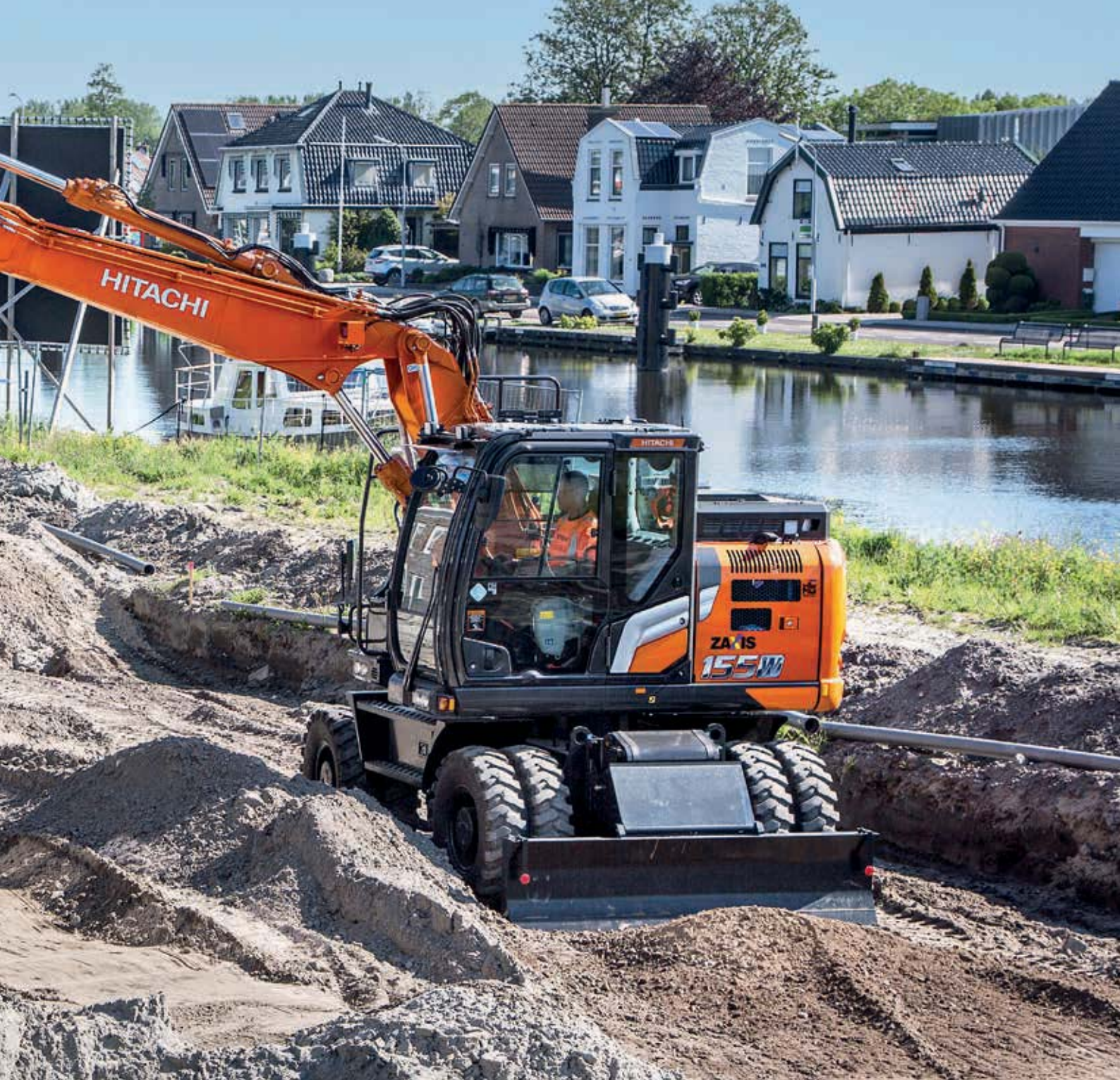
HIOS V hydrauliksystemet øger fronthastigheden og reducerer brændstofforbruget.
