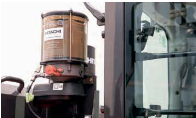
Automatisk smøresystem (ekstraudstyr) sparer tid.
