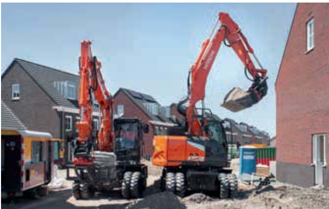
ZX135W-7 kan dreje inden for en radius på 3,5 meter (1.740 mm bagud og 1.750 mm foran).
