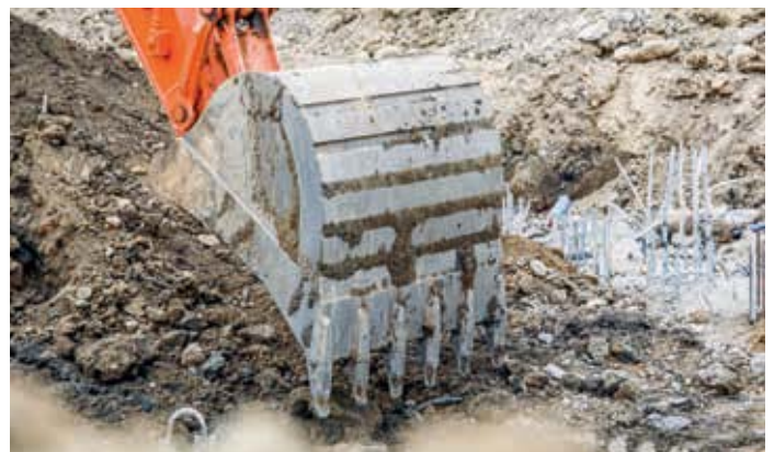
Hitachi GET omfatter selvsøkørende tænder og pålidelige adaptere for at sikre, at de passer nøjagtigt.
