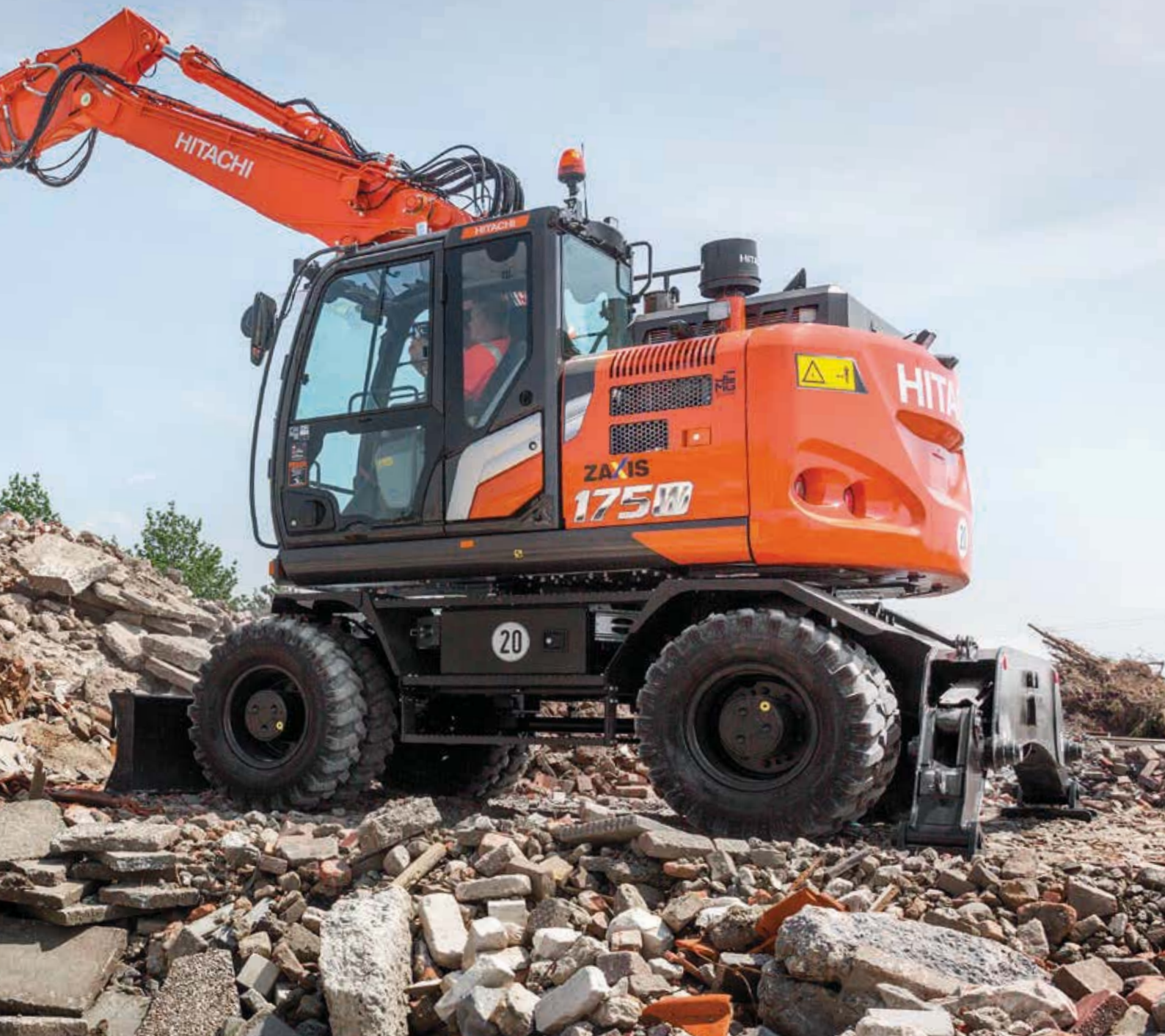
HIOS V hydrauliksystemet øger fronthastigheden og reducerer brændstofforbruget.
