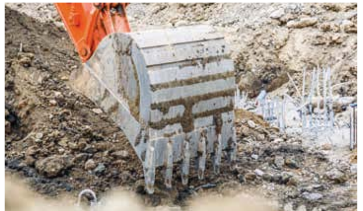
Hitachi GET omfatter selvskærpnde tænder og pålidelige adaptere for at sikre, at de passer nøjagtigt.
