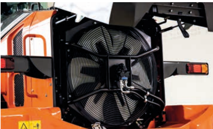
Den vendbar kølervinge forhindrer tilstopning af kølesystemet.
