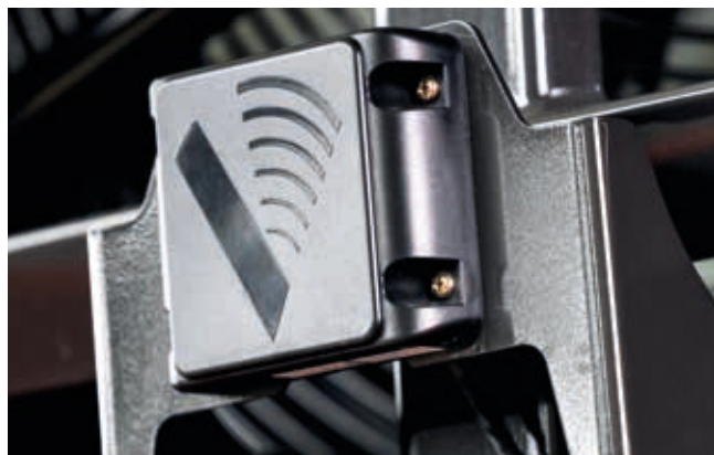
Det bagudvendte kamera med sensor og alarm øger sikkerheden på arbejdsstedet.
