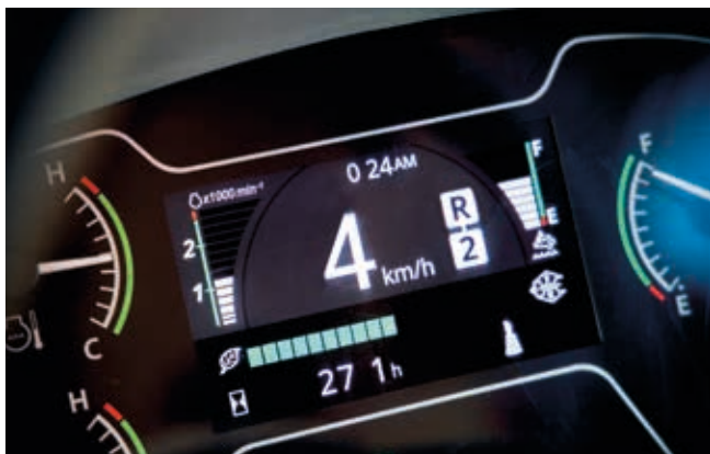
ECO-måleren hjælper med at opnå lavere brændstofforbrug.
