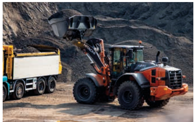
Hastighedsstyring forbedrer brændstoffektiviteten.
