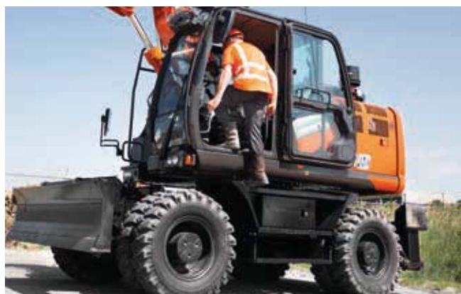
Det nederste første trin gør det mere sikkert og lettere at komme ind i førerhuset.
