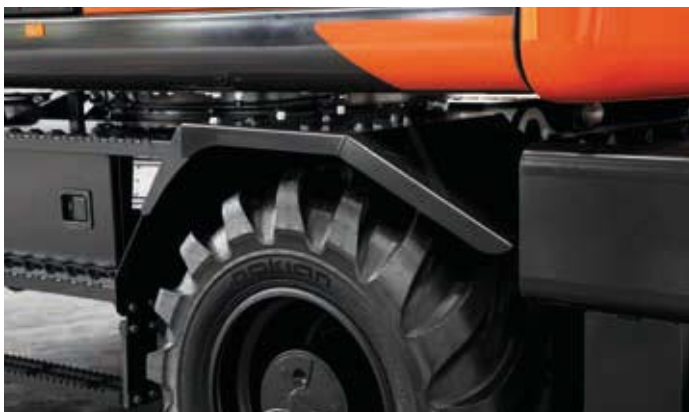
Skærme på undervognen beskytter overdelen og lygterne mod snavs, og holder maskinen ren.
