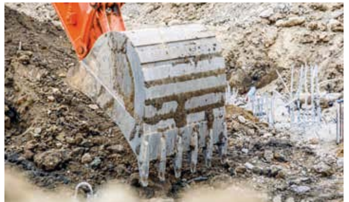
Hitachi GET omfatter selvsværpende tænder og pålidelige adaptorer for at sikre, at de passer nøjagtigt.
