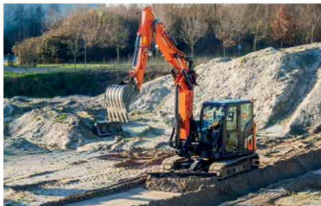
Det valgfrie blad med flydende vinkel er ideelt til planering og nivellering.
